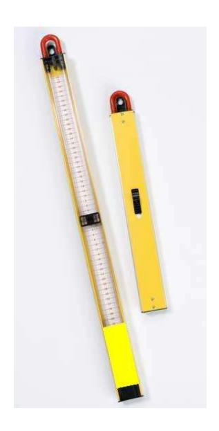
I manometri in ABS dispongono di un coperchio trasparente che protegge la scala millimetrata e facilita la lettura.
